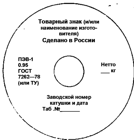
Рисунок А.2 — Расположение маркировки на ярлыке, прикрепленном к катушке
